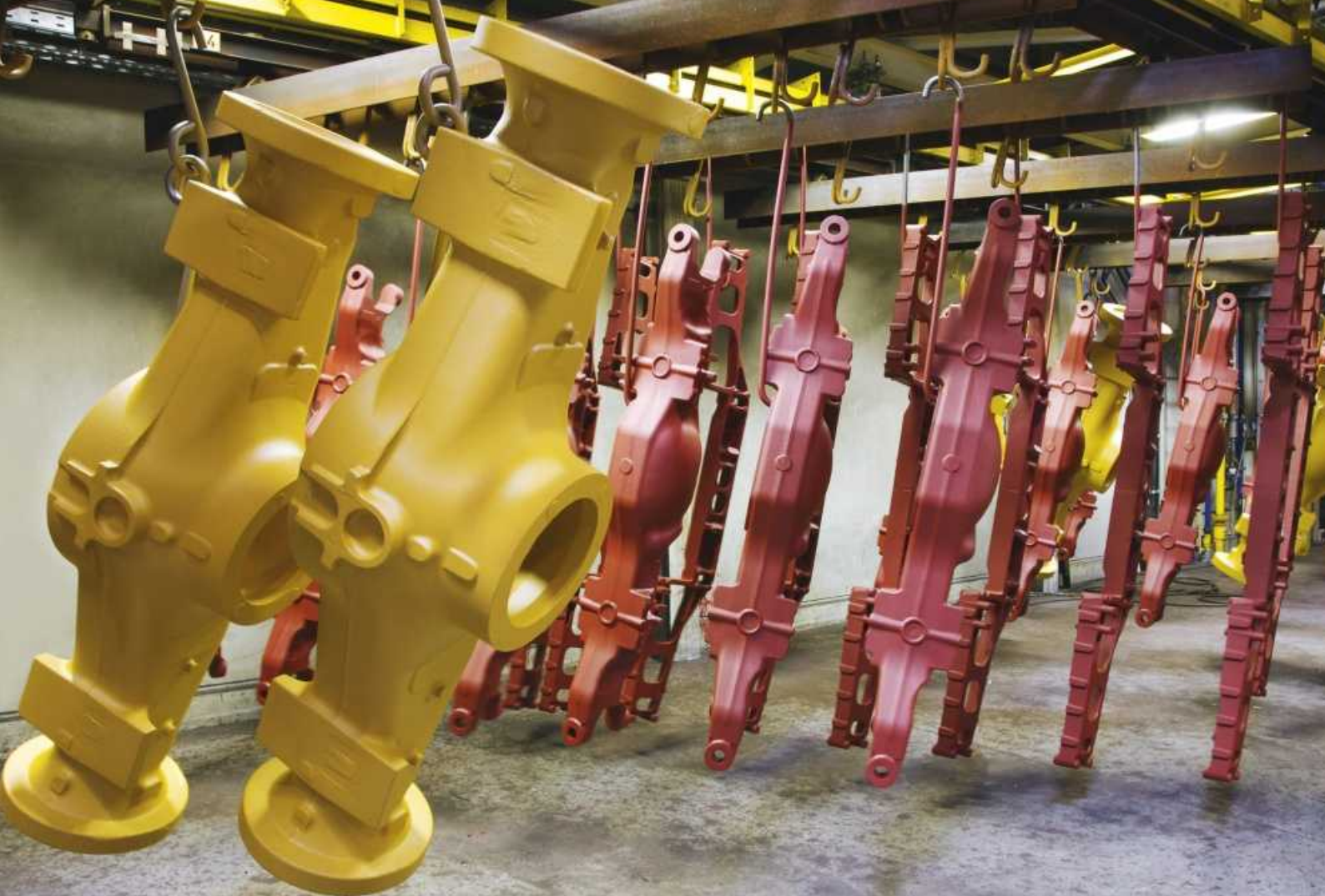
Maschinengeformte, frisch lackierte Achsenteile für Fahrzeuge von Caterpillar am GF Automotive Standort in Leipzig.
