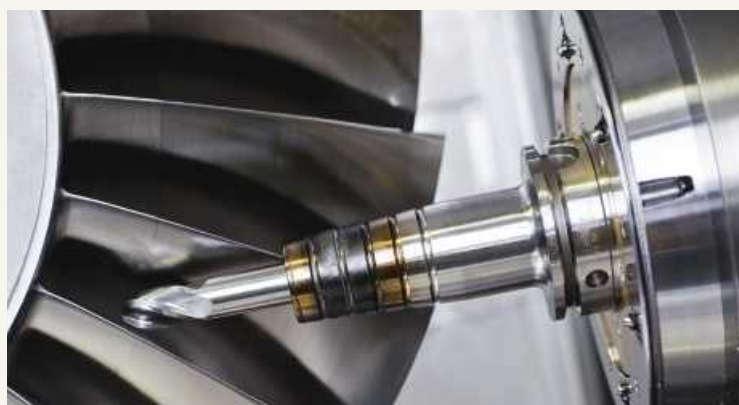
Maschine der Liechti Engineering AG bei der Herstellung von Blisks.
